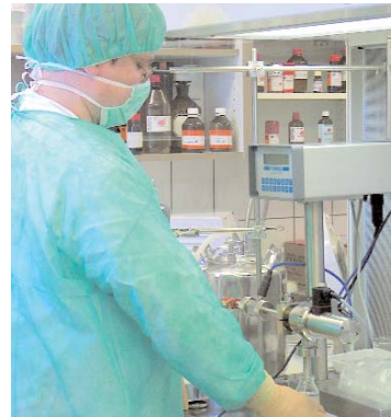
Eine spezielle Anlage erzeugt durch eine keimfreie Luftströmung (Air-LAF) Bedingungen, unter denen Pharmazeutika steril abgefüllt werden können.
